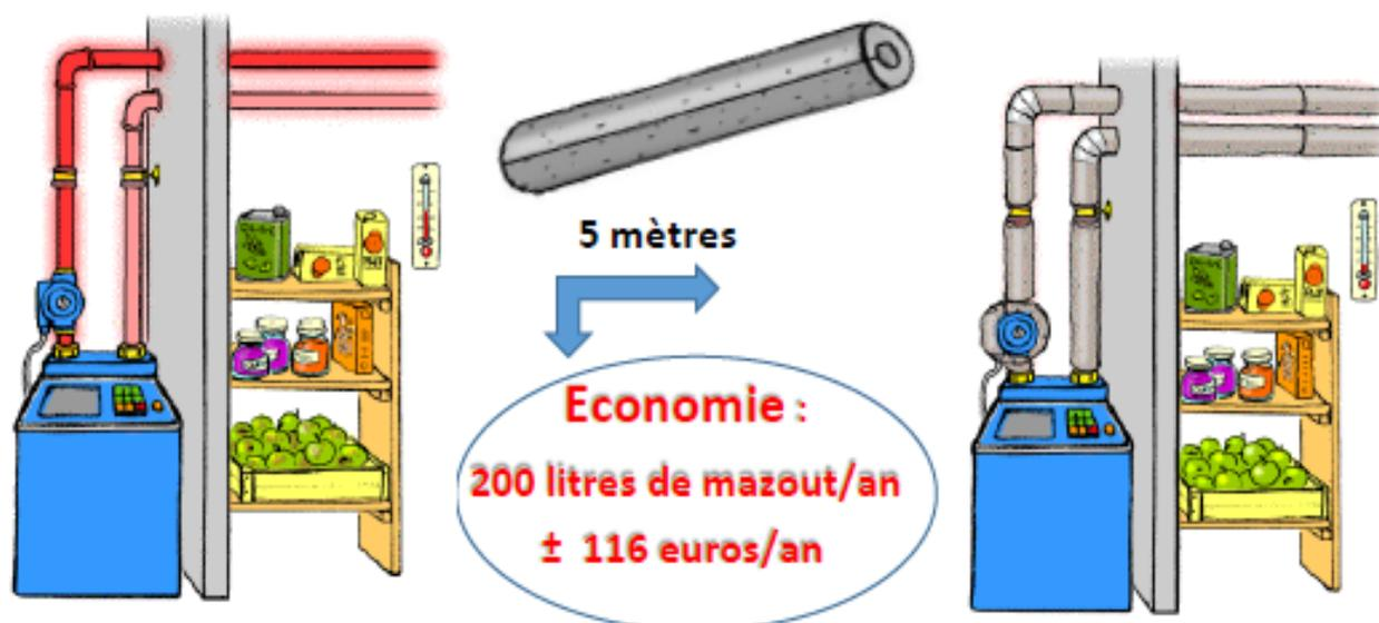
(Hypothèses de l'exemple : conduites de 20 mm – eau à 75°C – t° cave 15°C – durée de chauffe moyenne de ± 5800 heures/an – rendement saisonnier chaudière de ± 85 %) - Source : Illustration - <http://www.energie-environnement.ch/>; Exemple : <http://energie.wallonie.be/fr/chauffage-et-eau-chaude-sanitaire.html?IDC=8037>
