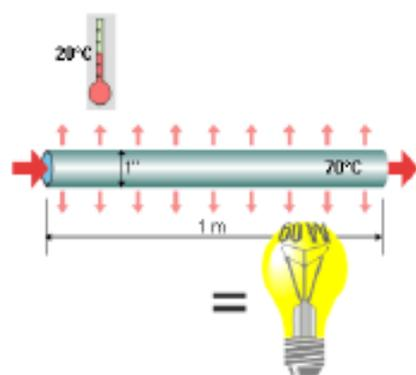
**1 m de tuyau en acier de 1 pouce de Ø, non isolé, dans lequel circule de l'eau chaude à 70°C et qui parcourt une ambiance à 20°C, a une perte équivalente à la consommation d'une ampoule de 60 W**
